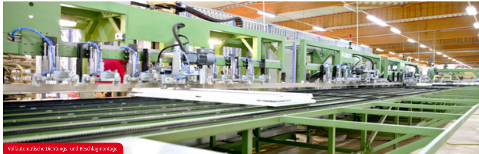
Vollautomatische Dichtungs- und Beschlagmontage
